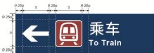
图2 标志版面尺寸关系示例
